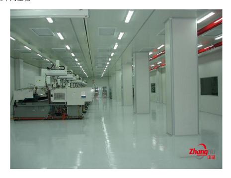
无尘车间不同级别空气洁净度的空气过滤器的选用、布置要点:对于300000级空气净化处理,可采用亚高效过滤器代替高效过滤器;空气洁净度100级、10000级及100000级的空气净化处理,应采用初、中、高效过滤器三级过滤器;中效或高效空气过滤器宜按小于或等于额定风量选用;中效空气过滤器宜集中设置在净化空气调节的正压段;高效或亚高效空气过滤器宜设置在净化空气调节系统的末端。选址原则:无尘车间地址的选择应符合有利生产、方便生活、节省投资和经营费用的原则。厂址应设在自然环境和水质较好,大气含尘浓度较低,地形、地物、地貌造成的小气候有利于生产、节能的区域,应远离大量散发粉尘、烟雾、有毒害气体和微生物的区域,如机场、铁路、码头、交通要道等,并在污染源和全年主导风向的上风侧面,且有一定的防护距离。无尘车间与交通主干道间距宜50米以上。陕西千级医药无尘车间建设中湖洁净无尘车间的优势。欢迎来电咨询!
